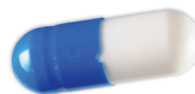
ささくれ、カット不良、割れ
